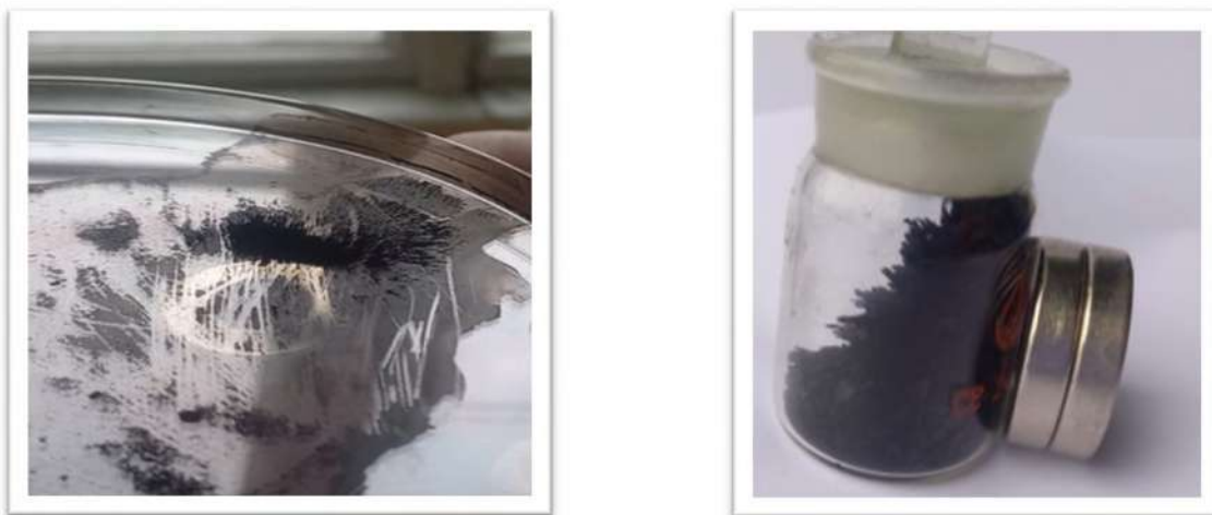
Рис. 3.1. Зовнішній вигляд та реакція на неодимовий магніт синтезованого магнетиту
