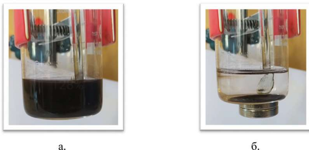
Рис. 3.2. Вплив магнітного поля на суспензію магнетиту а. Суспензія \text{Fe}_3\text{O}_4 , б – відділення із розчину з допомогою магніту який «прилип» до дна стакана.
