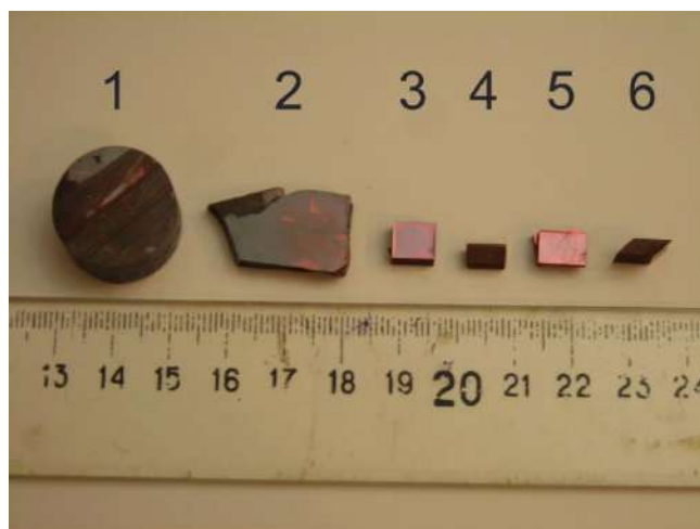
Рис. 4.64. Монокристали \text{TlGaSe}_2 та виготовлені орієнтовані зразки: 1, 2 – монокристали; 3 – x ; y ; z ; 4 – y=6.4 мм; (101)=4 мм; (101)=3.5 мм; 5 – z=3.8 мм; (110)=8.0 мм; (110)=6.0 мм; 6 – x=7.0 мм; (011)=3.0 мм [84].
