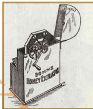
Рисунок 1.1 – Одна з перших стільників, у яких стільники оберталися у вертикальній площині. Малюнок узятий з американського журналу "Gleanings in Bee Culture" за листопад 1893 року. [2]
