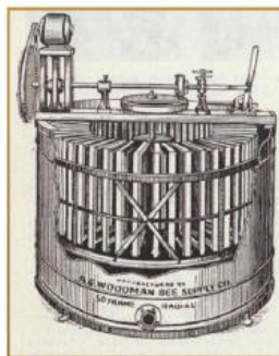
Рисунок 1.4 – Радіальні стільники Вудмана на 50 рамок, у яких стільники не потрібно перевертати. [2]
