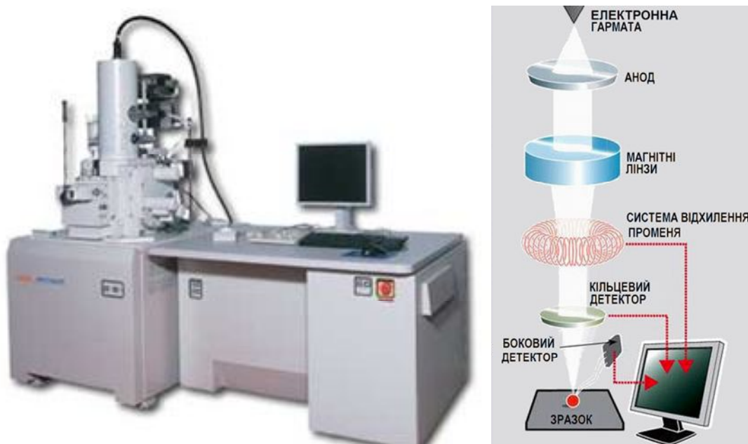
Рис. 1.8. Загальний вигляд та принцип роботи растрового електронного мікроскопа FE-SEM Hitachi S-5200 with EDS. [92, 93].
