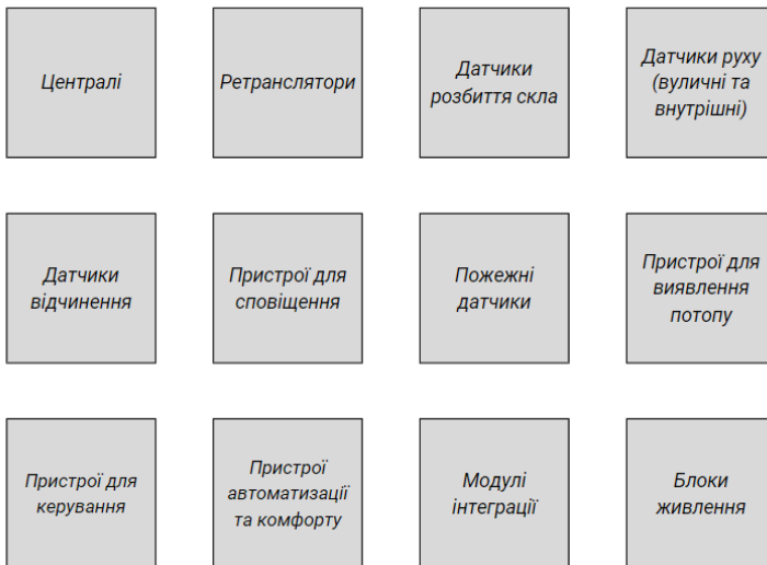
Рис. 3. Компонентний склад (основні модулі) бездротових пристроїв (Jeweller) от Ajax
