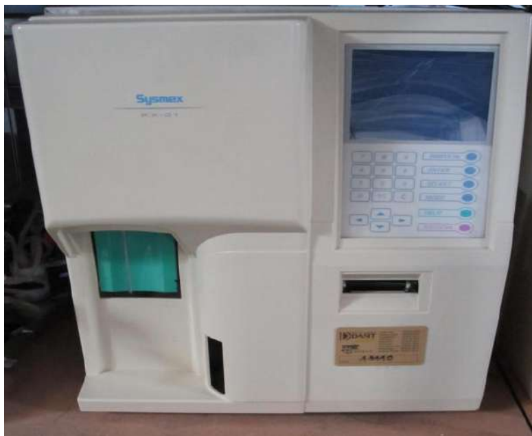
Рисунок 2.2 – Автоматичний гематологічний аналізатор «Sysmex KX-21».
