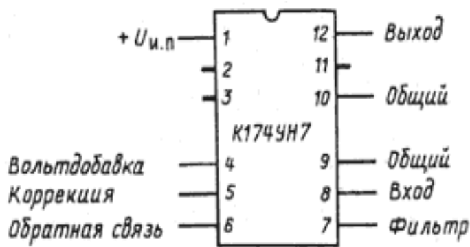
Рис. 6. Розташування і призначення виводів ІМС К174УН7
