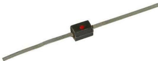
Рис. 3.7 Зовнішній вигляд діода [3]
