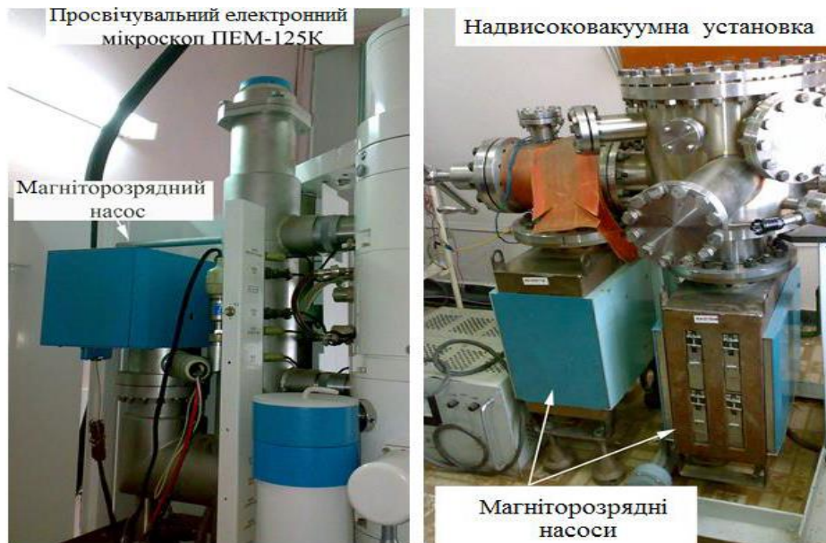
Рис.4.6а. Вакуумна система електронного мікроскопа ПЕМ-125К та надвисоковакуумної установки.
