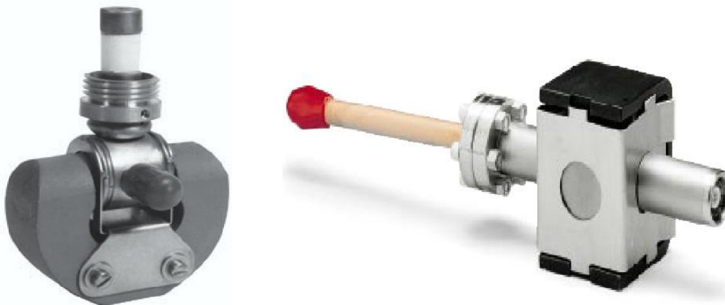
Рис. 4.6б. Магніторозрядні насоси: справа - Thermionics AIP-0,2Т (розміри 94×64×35); S_H=0,2 л/с; P_{гр}=10^{-9} Па. Зліва-Varian Vaclon Mini (розміри 63×54×54); S_H=0,4 л/с; P_{гр}=10^{-5} Па.
