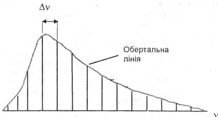
Рис.4. Схематичний вигляд чисто обертального спектру
