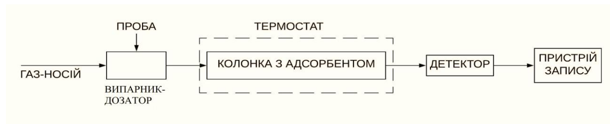
Рис. 3.16. Блок-схема газового хроматографа
