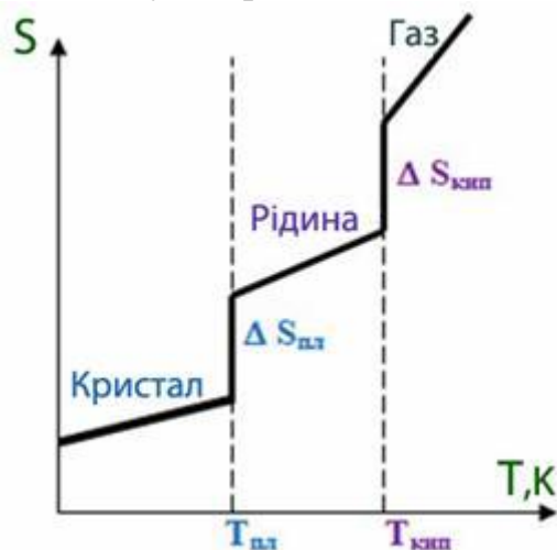
Рис. Характер змінення ентропії ( \Delta S ) речовини під час фазових перетворень при підвищенні температури
