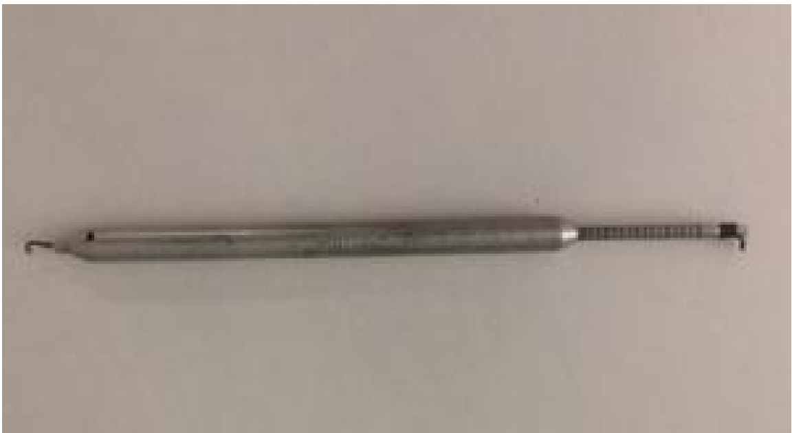
Рис. 5.6 Вимірювання сили натягу еластичного ланцюжка для мезіалізації молярів (а); зображення динамометра Dontrix ForceGauge (Orthodontic Supply and Equipment Co., США) (б).
