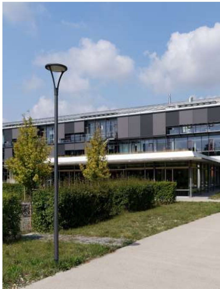
Рис 2.9 : Edge-lit pole-top luminaire
