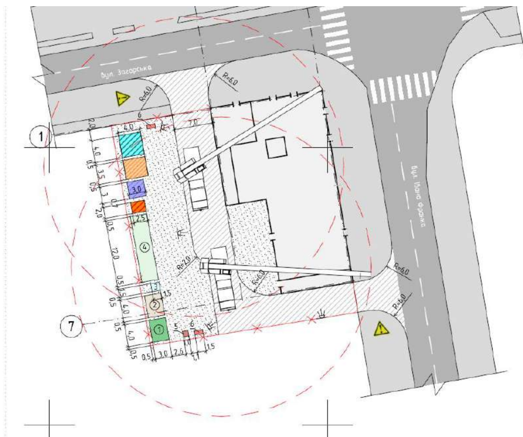
Рис.4.1. Будівельний генеральний план
