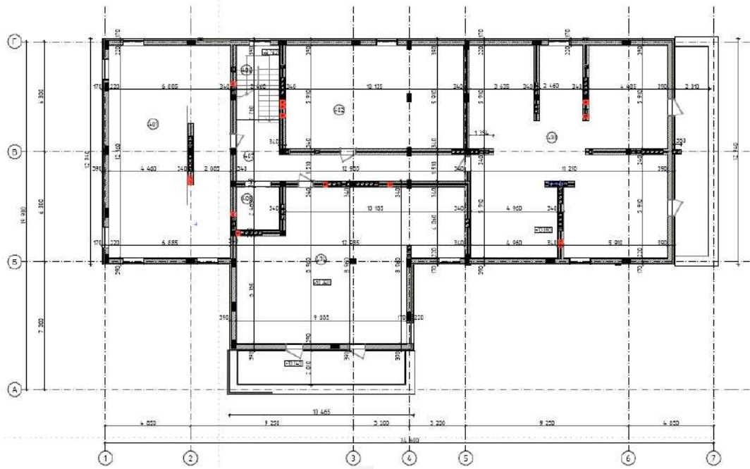
Рис.2.4. План технічного поверху житлового будинку
