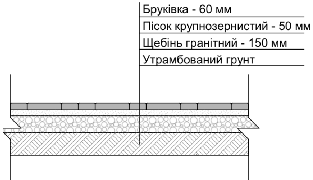
Рис. 1.5 Конструкція мощення
