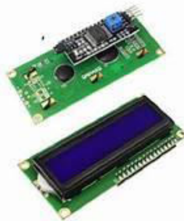
Рис. 1.11. – Зображення дисплею LCD I2C QC1602, та модуля розширення виводів для підключення до Arduino
