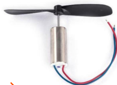
Рисунок 1.17. – Мотор з пропелером, розмір тіла: 6x16мм, розмір вала: 0,8x7мм, максимальна швидкість: 50000об / хв
