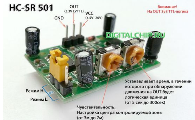
Рисунок 1.2. - Розміщення елементів налаштування та підключення ІЧ датчика руху
