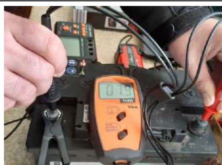
Фиг.1 Измерване на вътрешното съпротивление с волтметър модел VA203
