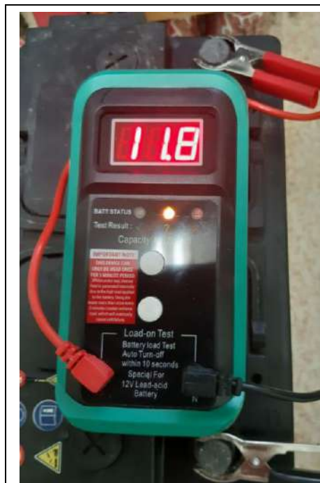
Фиг.3. Измерване на напрежение с товар
