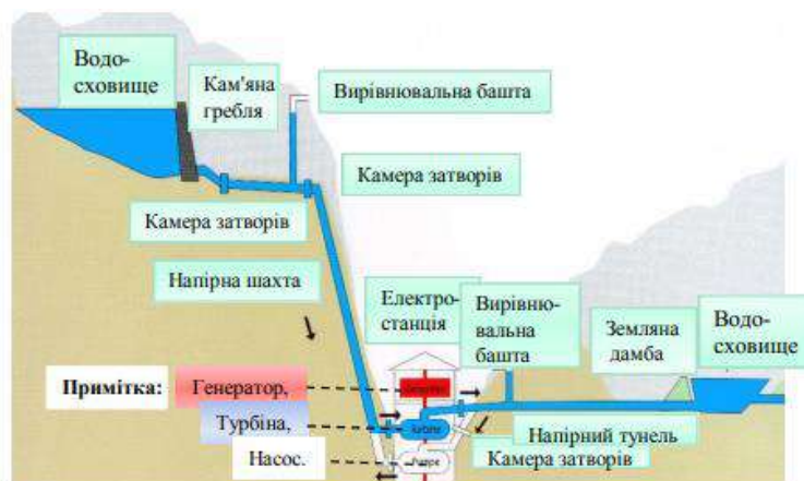
Рисунок 1 – Схема гідроакумуючої електростанції
