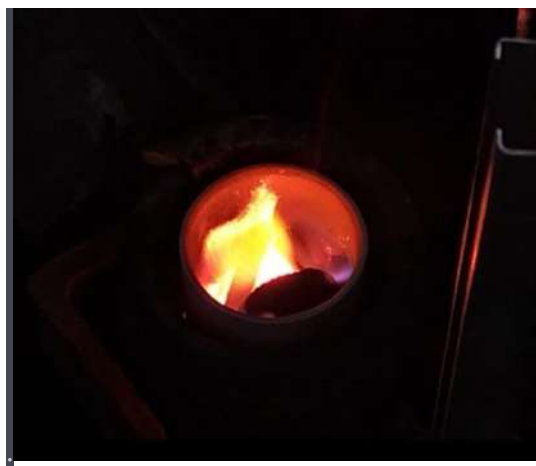
Рисунок 4 - Вуглетермічне відновлення брикетів в умовах індукційного нагріву.
