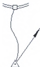
Мал.3. Одиночний хід полігонометрії
