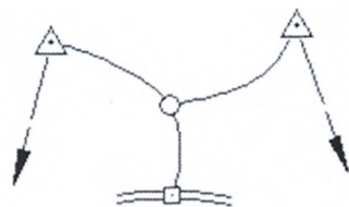
Мал.2. Система ходів полігонометрії з однією вузловою точкою
