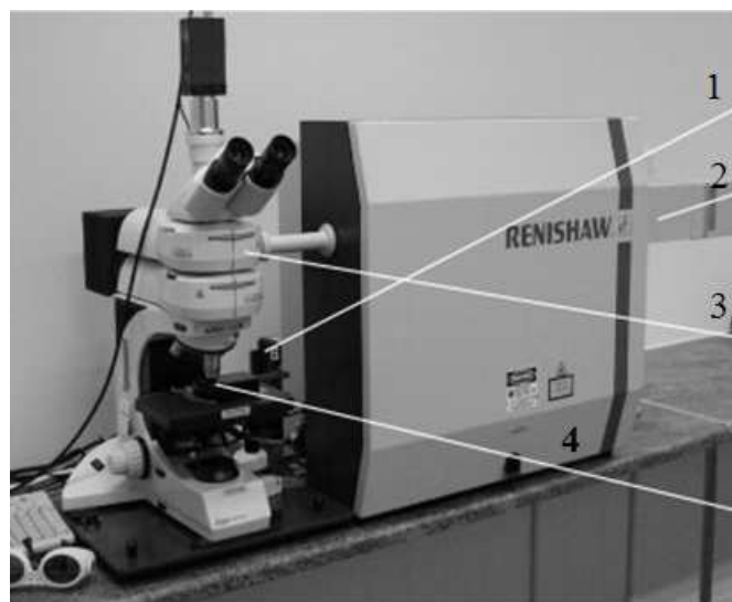
Рис. 2.3. Мікрораманівський спектрометр (загальний вигляд): 1 – лазер, 2 – детектор, 3 – мікроскоп, 4 – зразок [60].
